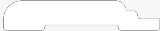
7 cm plat mdf groen 7 cm plat massief eik 7 cm plat massief beuk (verfkwaliteit) 7 cm plat massief esdoorn (verfkwaliteit) 7 cm plat massief WAWA (verfkwaliteit)
